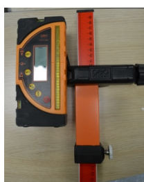
Figure 24 Fixation de la cellule (récepteur)
