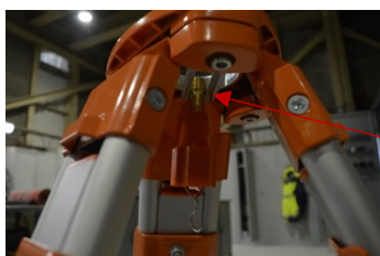
Figure 23 Fixation du Laser sur le trépied
